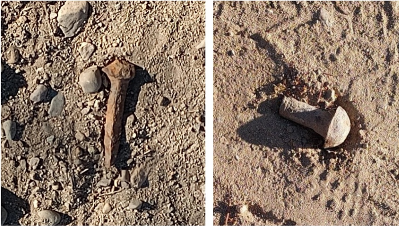
Figura 3: Clavo y Tornillo de ferrocarril. Fuente: Elaboración Propia.
